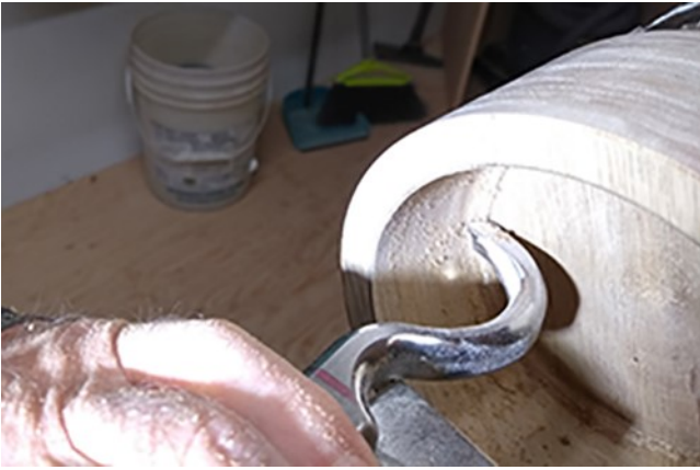
20-Creuser avec le col de cygne ou l'outil easy Wood Tool carré ou une gouge à creuser
