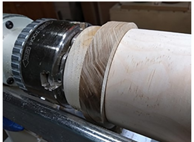
17– Assembler la boîte et le couvercle, si l'épaulement est trop gros, réduire par petites tranches jusqu'à ce que la boîte s'insère bien dans l'épaulement du couvercle
