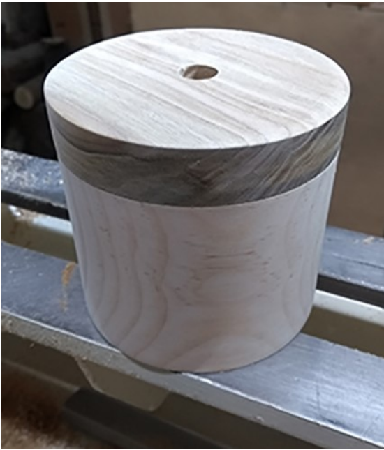
25- Percer le trou pour la poignée et poncer le dessus du couvercle
