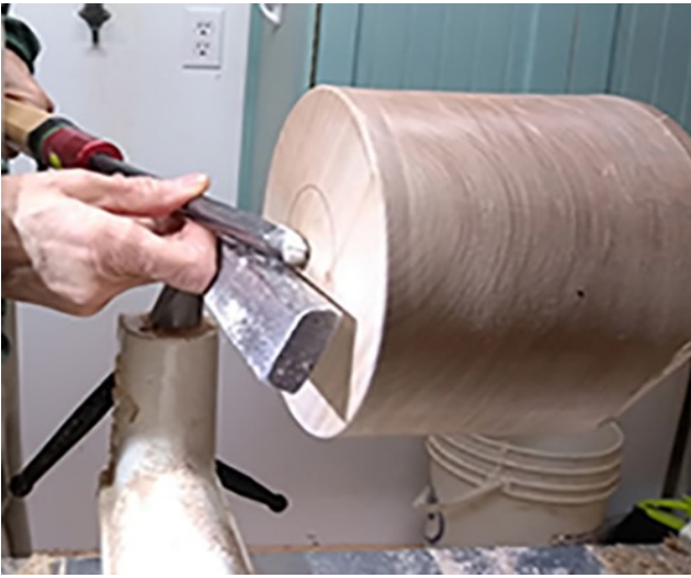
3-L'extrémité de la pièce doit être égalisée avant de réaliser la mortaise.
