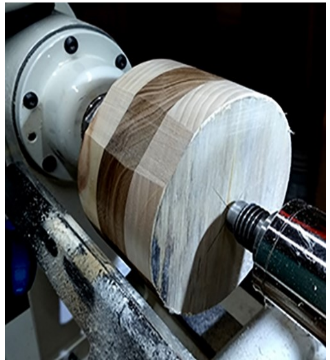
2- Installer la pièce sur le tour, utiliser la contre-pointe pour la sécurité et arrondir légèrement
