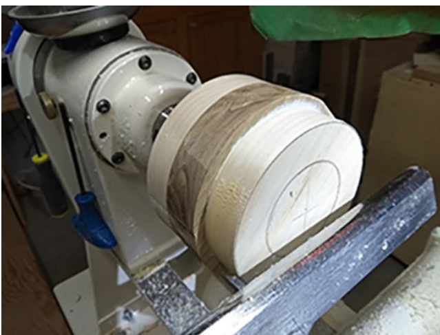
3- Tracer l'emplacement du tenon sur la pièce
