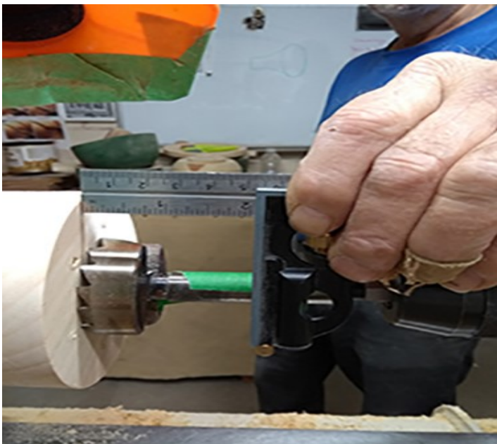
17- Avec l'équerre droite appuyée sur la pièce, tracer une ligne sur le ruban vert
