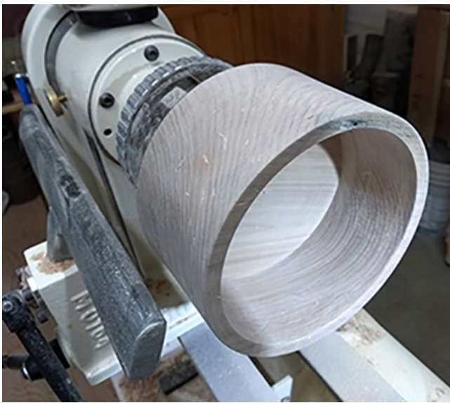
21- Creuser la boîte à la profondeur et épaisseur désirée
