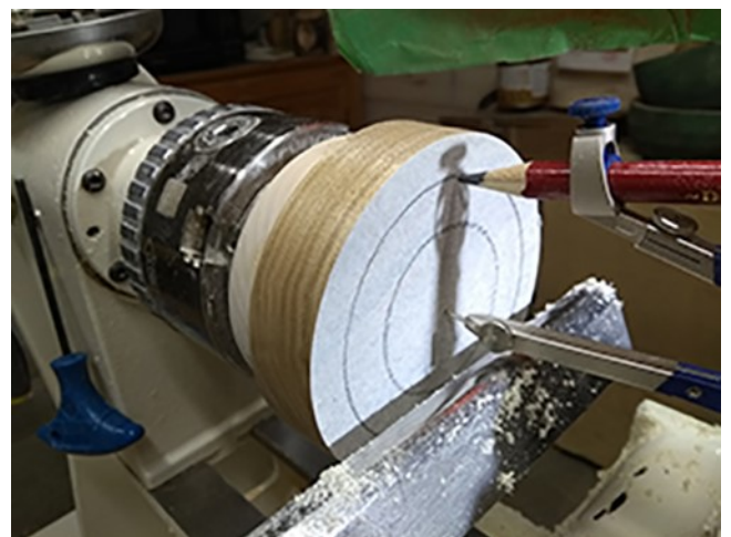
13- À partir du centre du couvercle, à l'aide du compas tracer le diamètre
