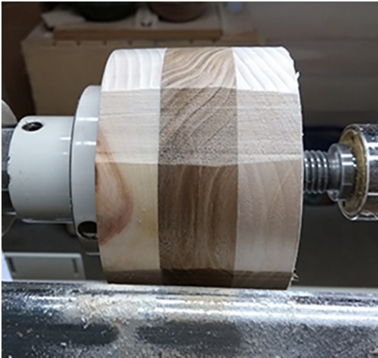
1- La pièce de bois est prise entre deux pièces sacrifice et montée sur le plateau de reprise
