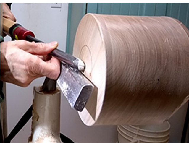
13-Égaliser la surface en préparation du creusage
