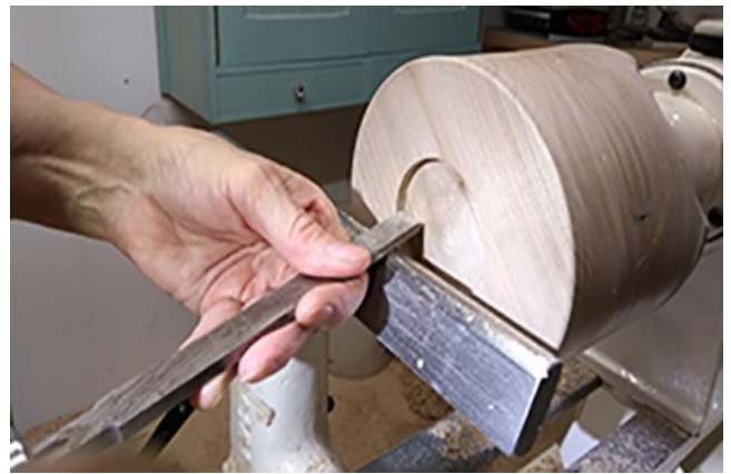
6-Avec la plane former l'angle de la mortaise
