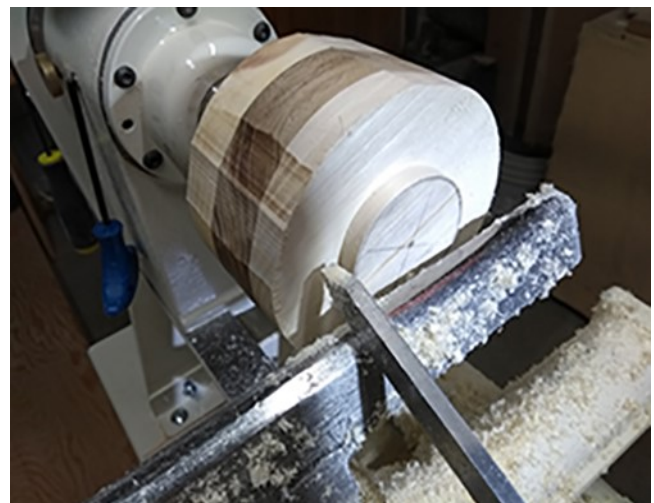
4- Réaliser le tenon avec le tronçoir et lui donner un angle
