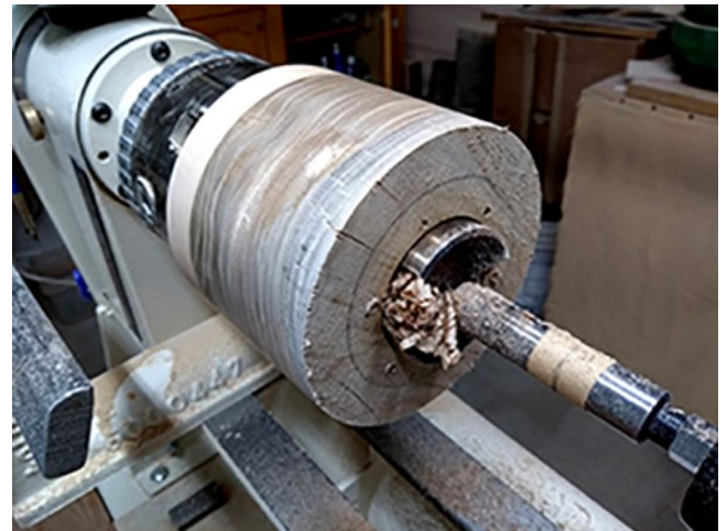
18- Avec une mèche forstner creuser jusqu'à la marque du ruban vert
