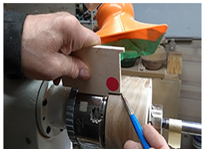
14-À l'aide d'un gabarit marquer l'arrêt du creusage pour le fond du boîtier
