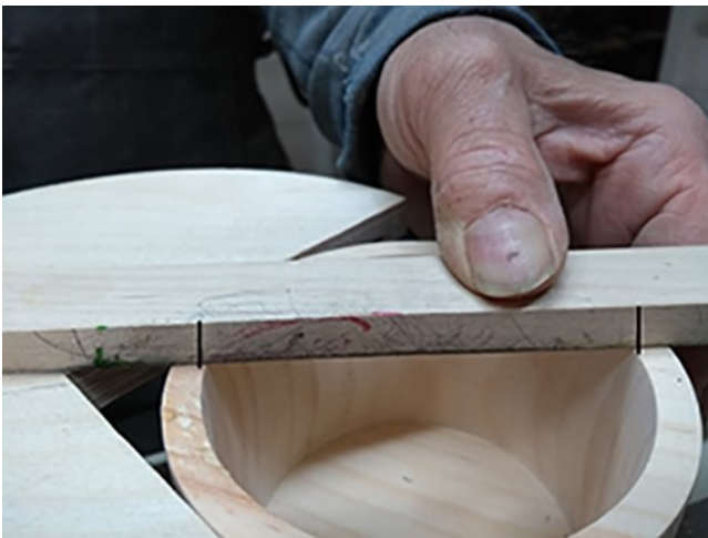
11- Placer une règle de bois sur la boîte, tracer deux petites lignes au crayon sur le côté de la règle, celles-ci indiqueront le diamètre de l'épaulement du couvercle
