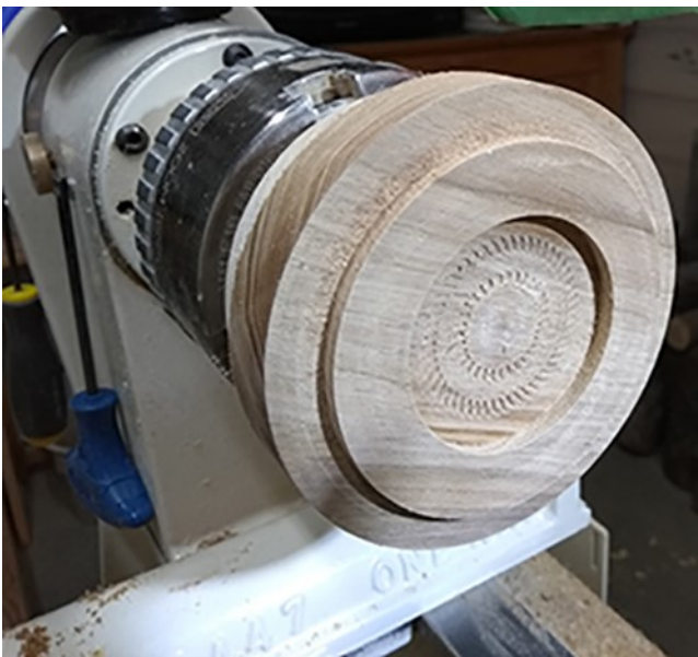
16– Creuser la mortaise, ajouter la texture à la mortaise et commencer la réduction de l'épaulement
