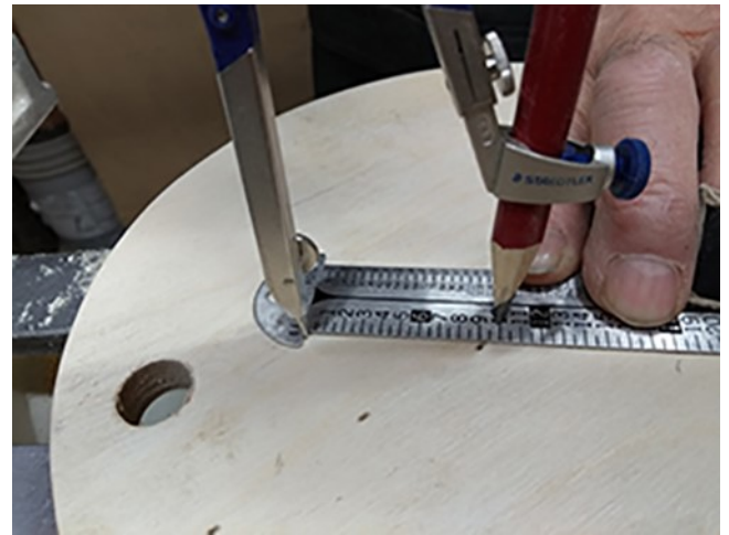
12- Mesurez la distance entre les deux marques, divisez par deux et ajustez un compas à cette valeur
