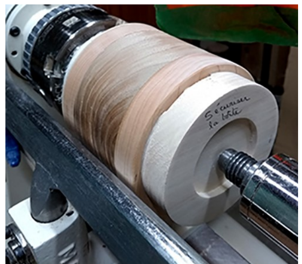
17– Assembler la boîte et le couvercle, si l'épaulement est trop gros, réduire par petites tranches jusqu'à ce que la boîte s'insère bien dans l'épaulement du couvercle
